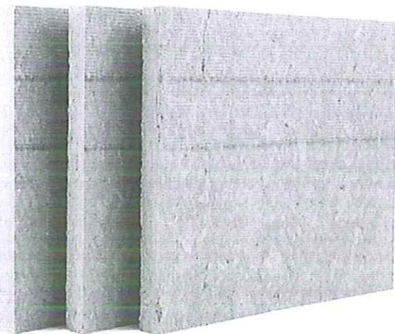
Приложить плиту ФТ БАРЬЕР Д к защищаемой железобетонной поверхности и пробурить 5 (для плиты 1000x600 мм) или 9 (для плиты 1200x1000 мм) отверстий для монтажа анкеров (количество точек крепления на 1 $m^2$  составляет 8,4 шт. для плиты 1000x600 мм и 7,5 шт. для плиты 1200x1000 мм). Длина анкера должна соответствовать толщине изоляции, приведенной в таблице:
