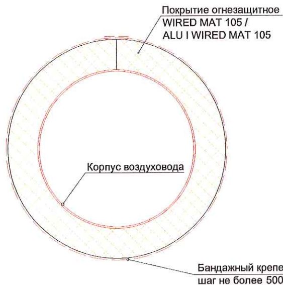
Рис. 7 а, б. Крепление огнезащитного покрытия WIRED MAT 105 / ALU I WIRED MAT 105 к воздуховоду с помощью бандажного крепежа или вязальной проволоки диаметром 2,0 – 3,0 мм.
