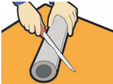
**1** ◉ Отрежьте сегмент трубки Energoflex® длиной достаточной для изоляции отвода.
