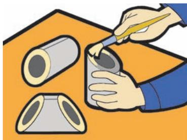
**3** ◉ Нанесите клей Energoflex® на торцы соединяемых сегментов.
