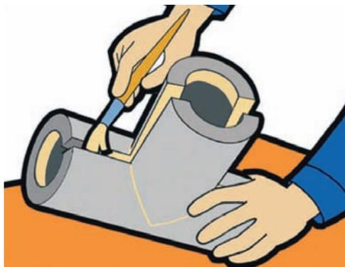
**1** Выполните изоляцию примыкающих к отводу трубопроводов так, чтобы теплоизоляция вплотную примыкала к фитингу.
