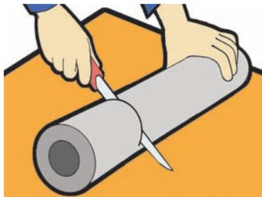
**1** Отрежьте сегмент трубки Energoflex® размером, равным трем длинам, необходимым для изоляции каждой из трубок тройника.
