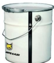
Акриловая краска на водной основе, без запаха, легко наносится и быстро сохнет, не загрязняет окружающую среду и не выцветает. Используется для покрытия изоляции как внутри помещения, так и снаружи. Выпускается объемом 2,5 л. Расход краски 0,45-0,5 л/м<sup>2</sup> в два слоя.
