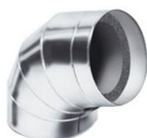
Готовые углы с сегментами по 45° или 90° с гибким краем стандартных размеров. Устанавливаются поверх теплоизоляции. Необходимый угол устанавливается на предварительно заизолированную часть конструкции так, чтобы его края немного перекрывали друг друга. Край фиксируется с помощью самоклеящейся ленты AL CLAD.
