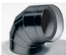
Готовые углы с сегментами по 45° или 90° с гибким краем стандартных размеров. Устанавливаются поверх теплоизоляции. Необходимый угол устанавливается на предварительно заизолированную часть конструкции так, чтобы его края немного перекрывали друг друга. Край фиксируется с помощью самоклеящейся ленты IC CLAD или IN CLAD.
